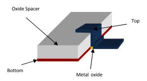
Figure 13. Edge diode structure
